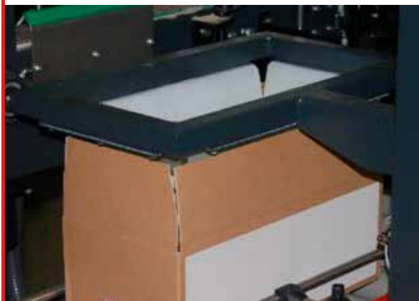
Pórtico abridor solapas
